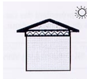
Techo en lámina de zinc con cumbreras cerradas o débilmente ventiladas
